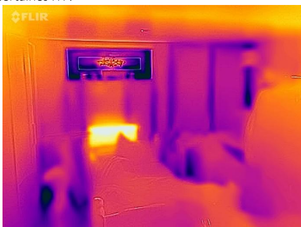
Figure 49 : Thermographie infrarouge d'une ITI présentant des ponts thermiques structurels importants.
