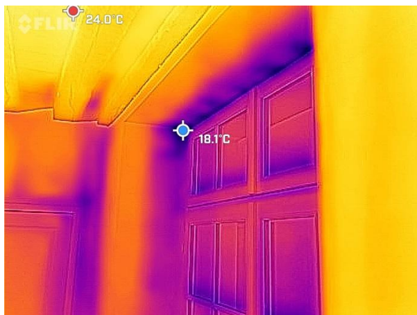
Figure 50 : Thermographie infrarouge du pont thermique entre une ITI et les menuiseries.
